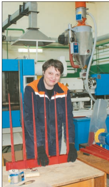
Устройство отпугивания птиц (УОП-Т) монтируется очень легко, из небольших деталей можно собрать линейку любой длины
